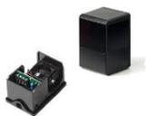
Cellules photoélectriques. Application en saillie, boîtier antichoc IP55 • Portée maximum 15m • Alimentation 12/24Vac-dc • Indice de protection IP55 • Émetteur et récepteur sous boîtiers étanches en matière plastique. • Commande: double relais avec contact inverseur en série.
