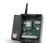
Récepteur avec afficheur LCD et fonction 2G/3G • Boîtier pour l'extérieur en ABS - IP55 • Cette unité peut accueillir jusqu'à quatre modules de canal interchangeables MCCMORPHM0, programmables en mode impulsion, ON/OFF ou temporisé. • Un relais inséré • Possibilité de mémoriser jusqu'à 3000 codes • Connexion USB et module 2G/3G pour la gestion des utilisateurs mémorisés et l'activation des sorties • Dimensions: 135x175x85mm • 12/24 Vac-dc
