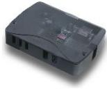
Décode le signal radio provenant d'un Morpheus et délivre en sortie un signal digital Wiegand/ISO-3554 contenant le code de l'émetteur activé en 13 formats différents. Est doté d'une connexion USB pour raccorder à un PC et d'une entrée pouvant être connectée à un temporisateur ou à un interrupteur pour valider ou bloquer l'interface en différentes tranches horaires. Gestion Rolling Code avec mémorisation de l'émetteur sur l'interface.
