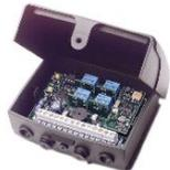
Récepteur Morpheus bi-directionnel 4 canaux • FM 433 MHz - Rolling Code • 1 module relais MORCA340 inclus • Sorties relais configurable: impulsion ou ON/OFF • Entrée supplémentaire par canal pour contrôle de l'état du système • Boîtier ABS (110x110x333 mm), IP44 • 1000 codes émetteur • 12-24 Vac/dc
