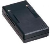
Emetteur 2 canaux S38 AM, 27MHz • Codage via 14 dip-switches • Pile fournie • Dimensions: 54x108x22mm
