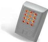
Clavier additionnel sans décodeur • Boitier alu IP55 72x104x26 mm • Maximum 1000 codes 1-6 chiffres • Choix de 1-4 sorties • Maximum 4 claviers par décodeur
