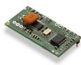
Module récepteur FM, 433 MHz avec quartz, sans décodeur, à enficher dans un récepteur Cardin • 5 Vdc-15 mA • Dimensions: 40x17x13 mm
