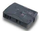
Récepteur multi-protocoles pour intégration, S486, FM Rolling Code, 868 MHz . • Pour décodage émetteurs S486 ou clavier à code DKS250 (filaire) • Protocoles de sortie: Wiegand - ISO-3554 - RS232 (13 formats différents) • Entrée: 1 contact filaire pour gestion récepteur par timer externe, etc • Fourni avec software de gestion sur PC par RS232 • Alimentation: 12/24 Vac, 20 mA • Boîtier ABS: 120x85x20 mm
