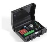
Récepteur séquentiel, S504 FM, • Rolling Code 230 Vac • Pour gestion d'éclairage 2000 W • ON/OFF ou temporisé (1 min - 9h59 min) • Boitier échanche IP55 • Entrée d'activation • Maximum 1000 codes émetteur • Dimensions: 139x115x44mm
