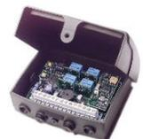
Récepteur S486 FM 868 MHz • Rolling Code • 1 à 4 canaux + 1 SP1/NO"N" • 300 codes
