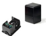
Cellules photoélectriques. Application en saillie, boîtier antichoc IP55 • Portée maximum 60m • Alimentation 12/24Vac-dc • Indice de protection IP55 • Émetteur et récepteur sous boîtiers étanches en matière plastique. • Commande: double relais avec contact inverseur en série. • Potentiomètre pour le réglage de la sensibilité sur le récepteur
