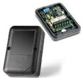
Cellules photoélectriques avec boîtier antichoc IP54 • Portée maximum 10m • Alimentation 12/24Vac-dc • Indice de protection IP54 • Température de fonctionnement -10...+55 °C • Dimensions 65 x 92 x 22mm. • Émetteur et récepteur sous boîtiers étanches en matière plastique. • Commande: double relais avec contact inverseur en série.
