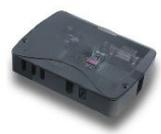
Récepteur multi-protocoles pour intégration, S449, FM "Rolling Code", 433 MHz • Pour décodage émetteurs S449 ou clavier à code DKS250 (filaire) • Protocoles de sortie: Wiegand - ISO-3554 - RS232 (13 formats différents) • Entrée: 1 contact filaire pour gestion récepteur par timer externe, etc • Fourni avec software de gestion sur PC par RS232 • Alimentation: 12/24 Vac, 20 mA • Boîtier ABS: 120x85x20 mm
